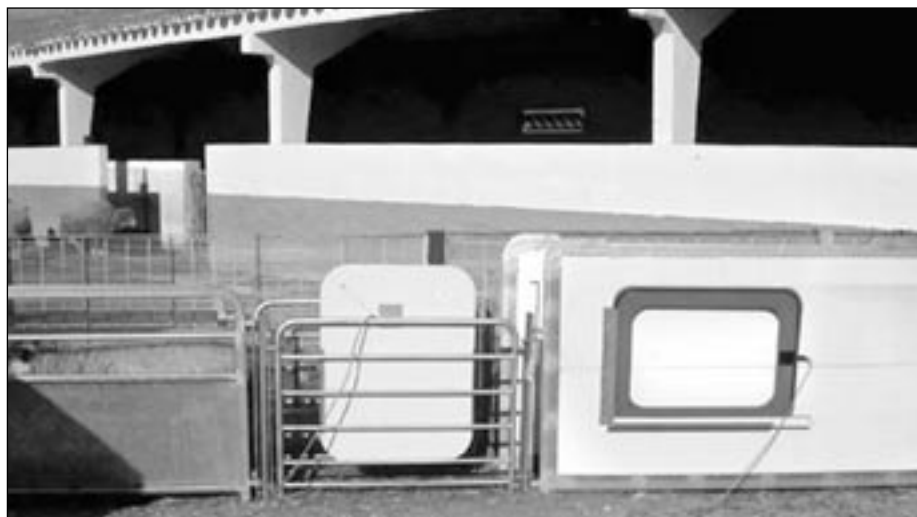
Príklad stacionárneho čítacieho zariadenia.
